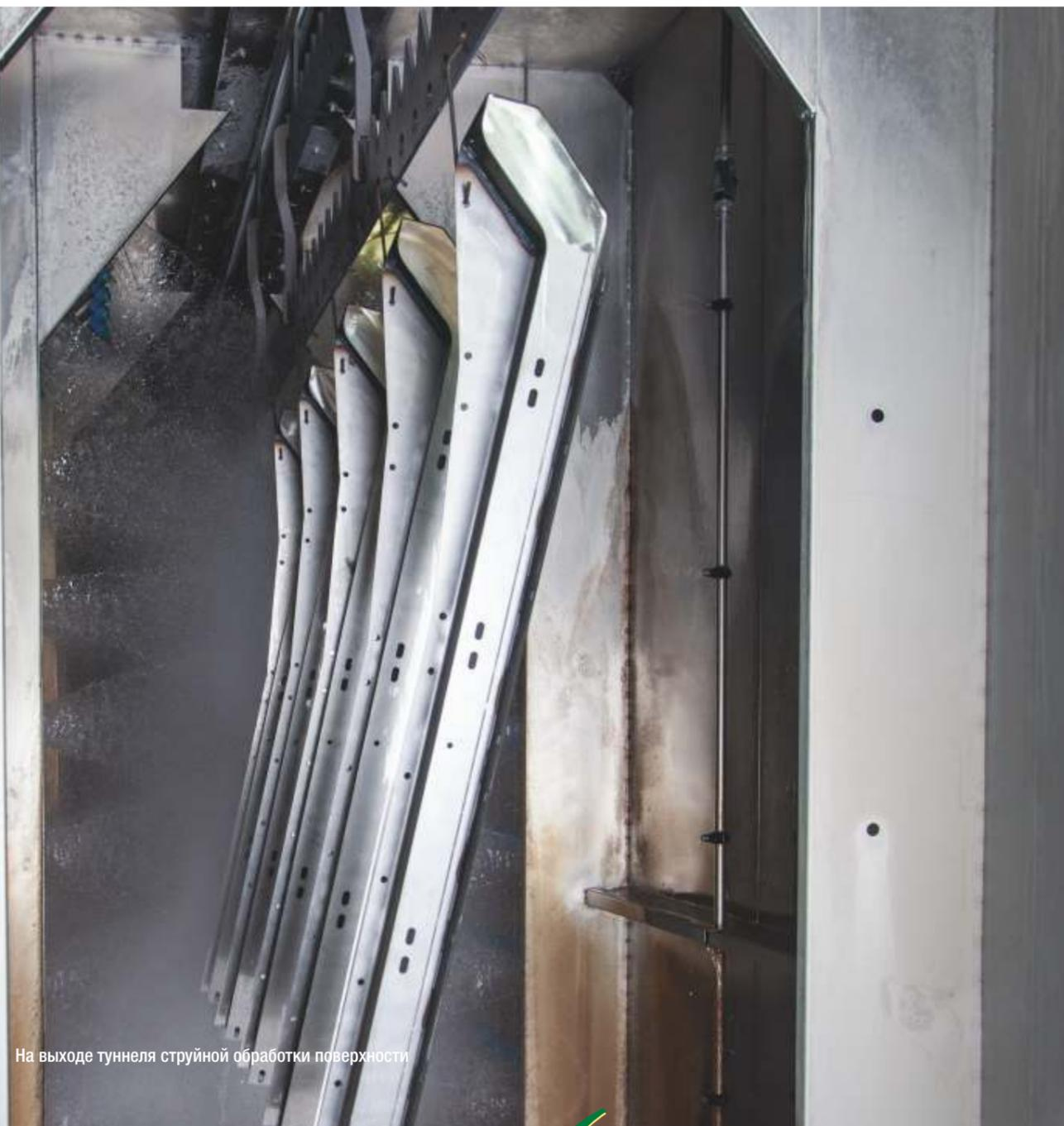
На выходе туннеля струйной обработки поверхности
