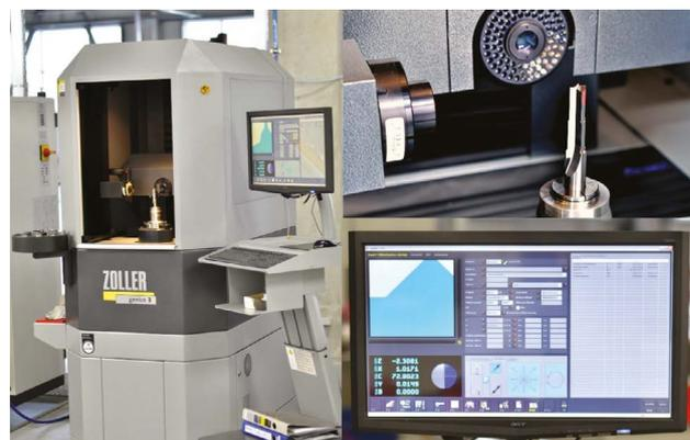
ИЗМЕРИТЕЛЬНОЕ ОБОРУДОВАНИЕ ZOLLER - КОНТРОЛЬ ГЕОМЕТРИИ И ИЗНОСА РЕЖУЩИХ ИНСТРУМЕНТОВ
