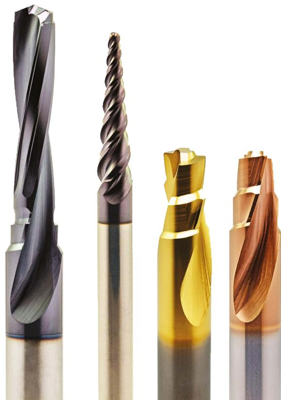
**8. TiSiN** - Многослойное нанокompозитное покрытие с твердостью примерно 3500 HV и макс. рабочей температурой 1100°C. Свойства покрытия предназначены для защиты режущей кромки от теплопередачи, окисления и истирания.
