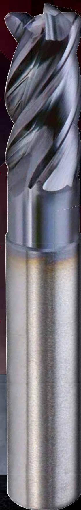
**Криволинейная форма торцевых режущих кромок** повышает их надёжность и позволяет применять увеличенные углы при линейном врезании и винтовой интерполяции.
