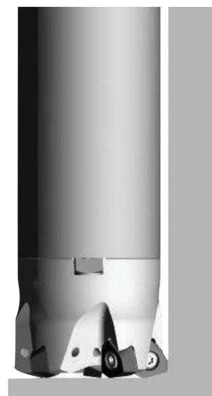
Рекомендуется при работе на больших вылетах благодаря пониженным радиальным усилиям резания. Максимальный вылет  $L/D$  составляет  $10 \times D$ .
